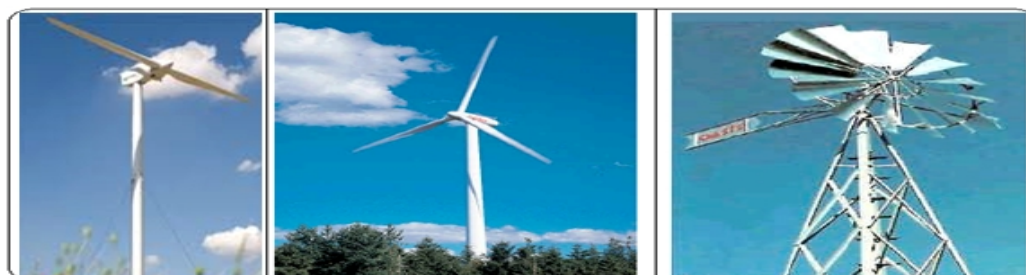
a-Éolienne bipale b-Éolienne tripale c-Éolienne multipale Figure I.6. Éoliennes à axe horizontal.
