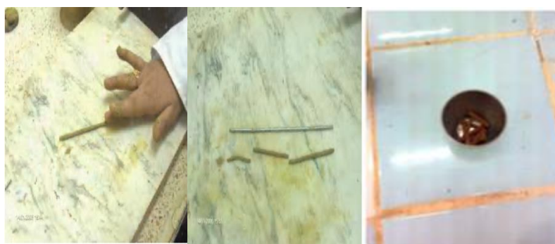
Figure II.13 : Limite de Plasticité [5].
