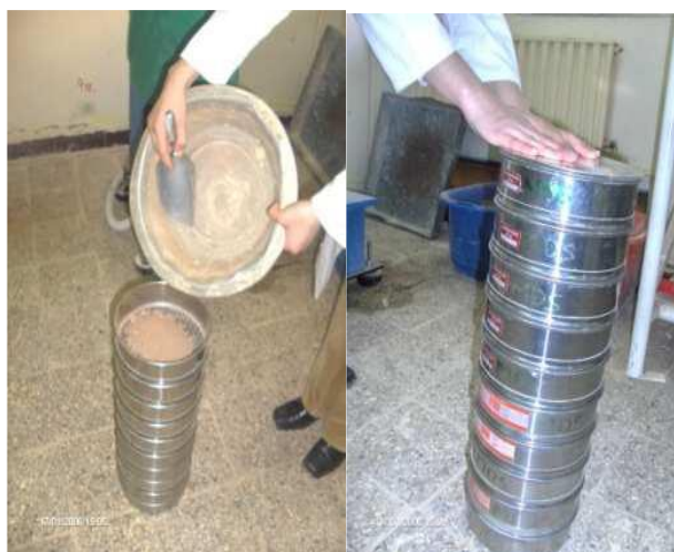
Figure II.6 : Essai de Granulométrie par tamisage [5].
