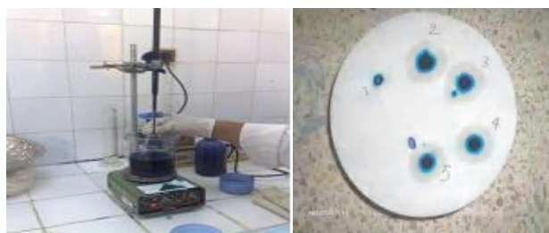
Figure II.16: Essai au Bleu de Méthylène [5].
