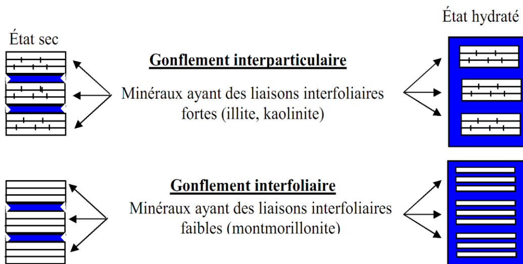
Figure.I.12 : Mécanismes de gonflement des argiles par hydratation D'après Popescu (1986) [1],
