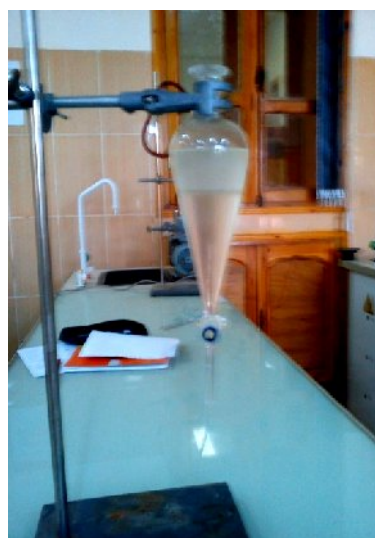
Figure 09 : La séparation liquide-liquide.
