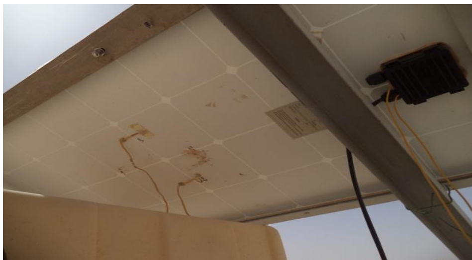
Figure IV-2: Thermocouple du type K placé à l'arrière du module PV.
