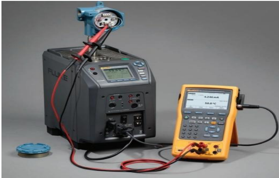
Fig.III.8. Montage de calibration de transmetteur de température [ GRN]
