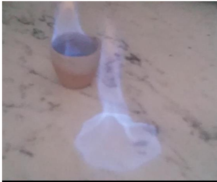
Photo 8: L'inflammabilité du bioalcool après la distillation
