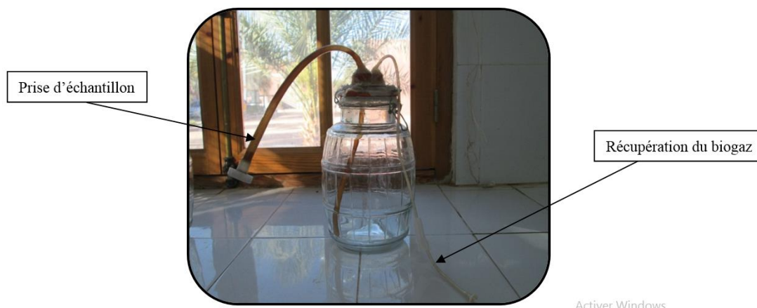
Photo 4: Le réacteur de digestion
