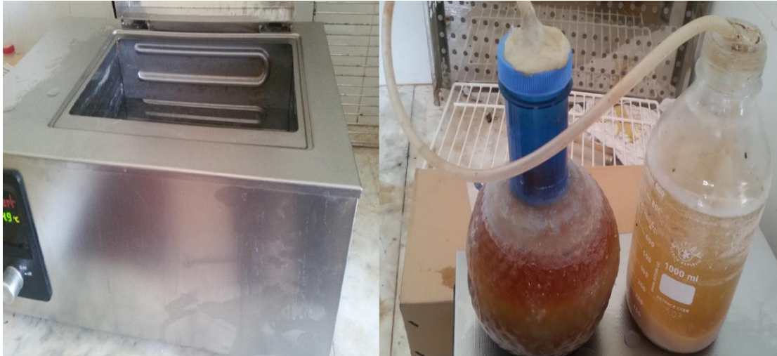
Photo 2: Le bain-marie et le réacteur de fermentation
