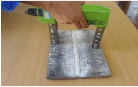
Figure7: schéma de Magnétisation par un électro-aimant mobile.
