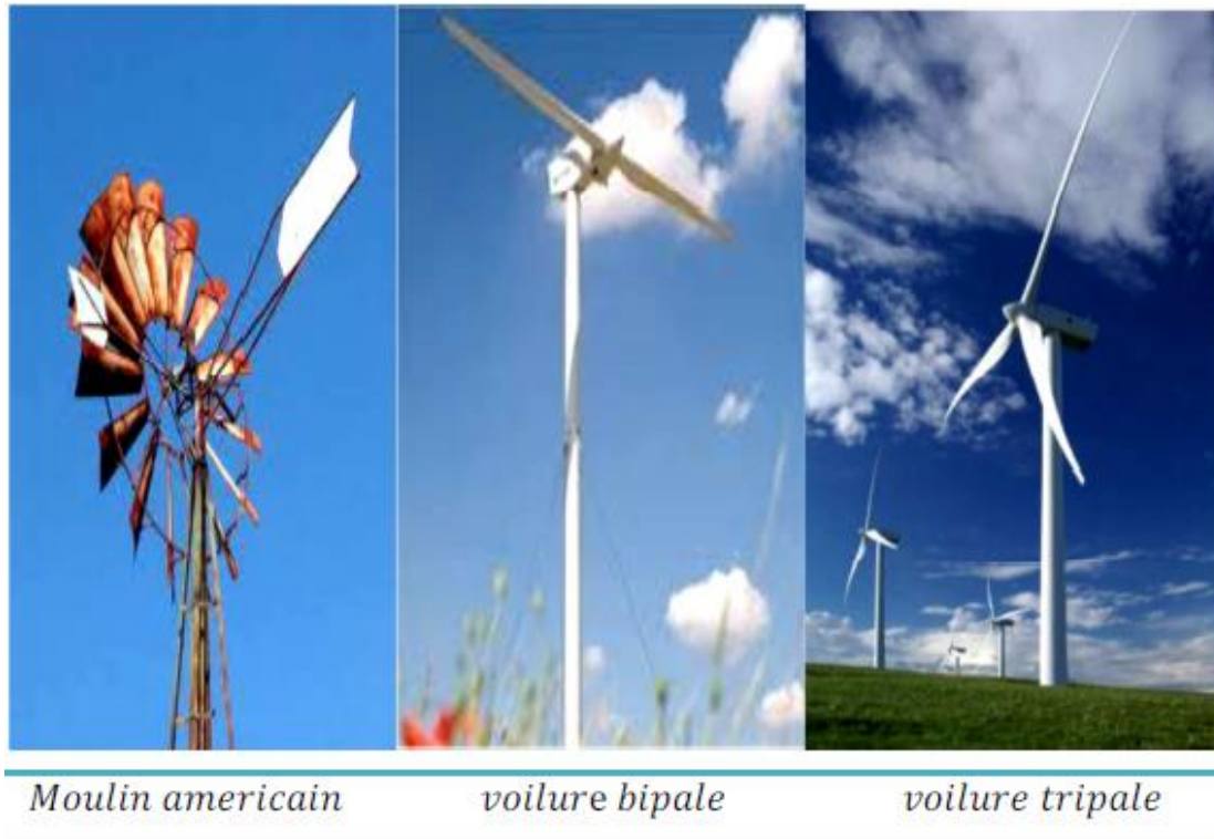
fig.I.17 technologie éolienne à axe horizontale [14].
