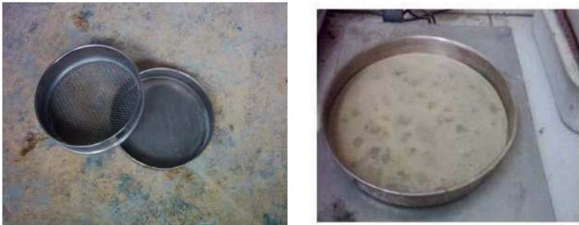
Figure I.09 : Tamis de 5mm+fond-mesure de la laitance [13].
