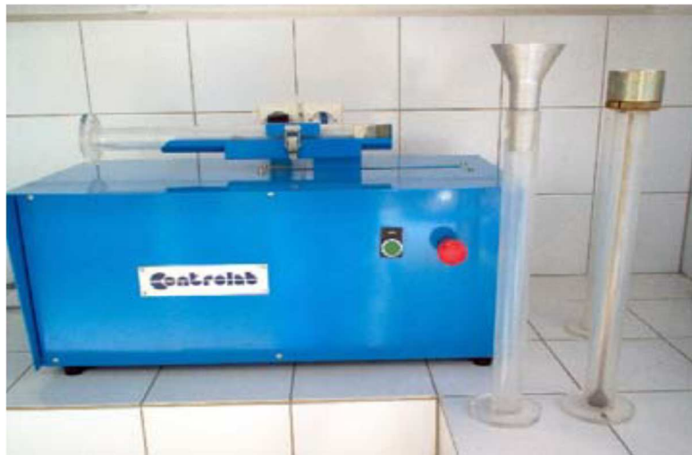
Figure II.03 : équipements nécessaires pour l'équivalent de sable.
