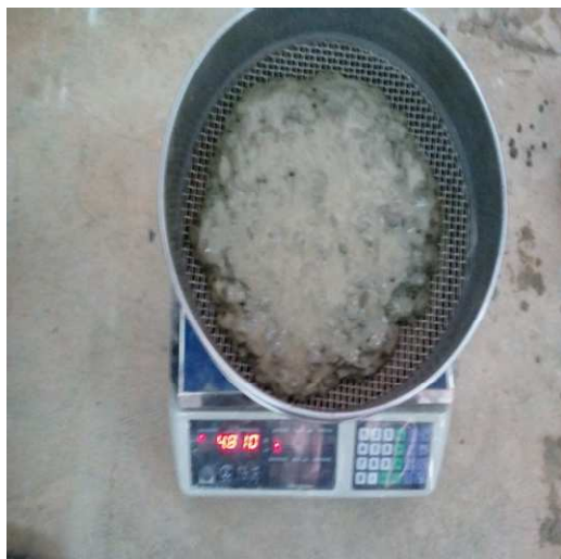
Figure III.07 : Stabilité au tamis.
