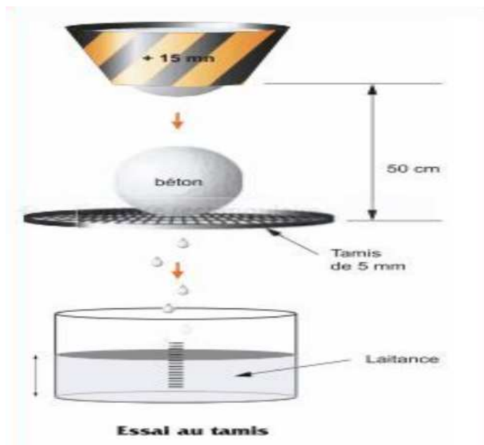
Figure III.06 : Essai au tamis.
