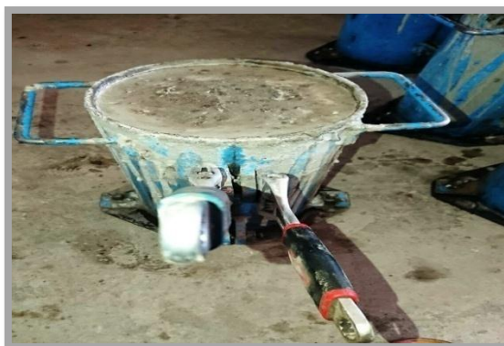
Figure 44: le démoulage des éprouvettes
