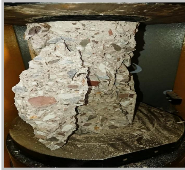
Figure 54: Epreuve écrasée par compression
