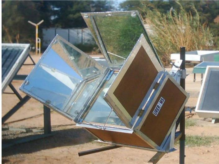
الشكل 1: صورة توضح نموذج المطبخ الشمسي علبه المصنوع ب "و.ب.ط.م.و.ص" بأدرار
