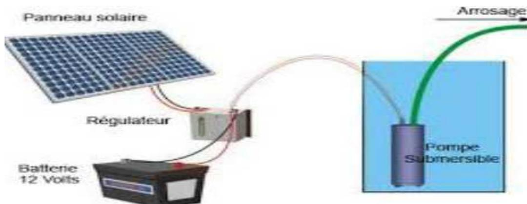
Figure 2.1 : Système de pompage avec batterie [6]
