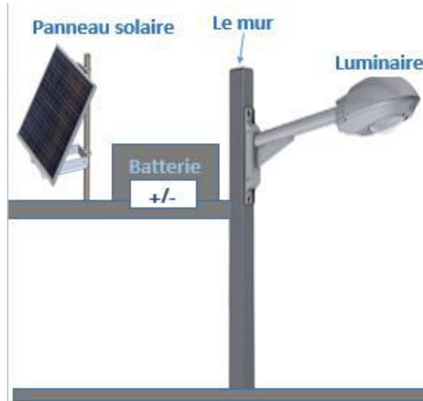
Figure 3. 6 : Crosse fixé au mur
