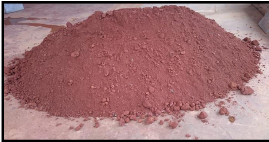
Figure.7 : Préparation de mélange de BTC.
