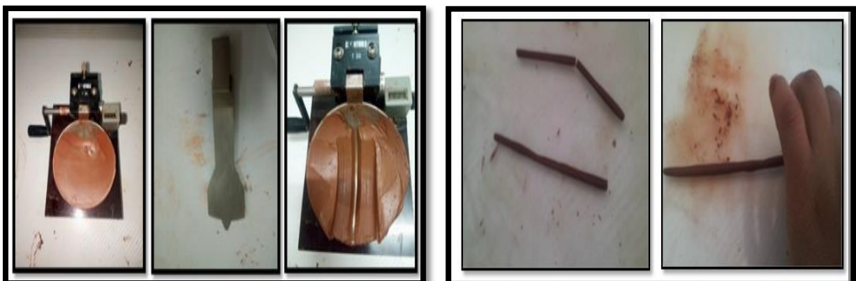
Figure.36 : Détermination de WL et WP.
