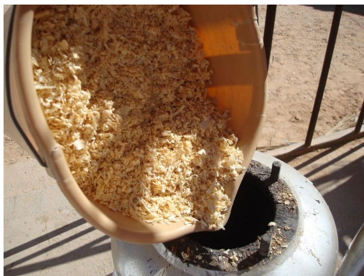
Figure 20 Alimentation du gazéificateur
