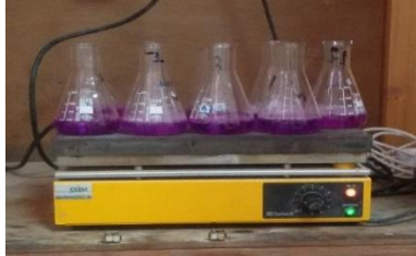
Photo 45 : Échauffement du mélange échantillons + réactifs.
