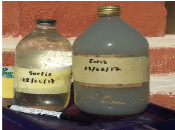
Photo 50 : La variation de la couleur à l'entrée et à la sortie de la station.
