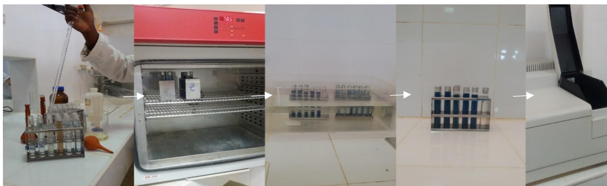
Photo 41 : Les étapes de détermination de la teneur des échantillons en orthophosphate.
