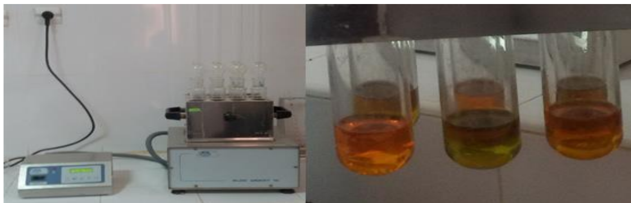
Photo 42 : Échauffement du mélange (échantillons + réactifs).
