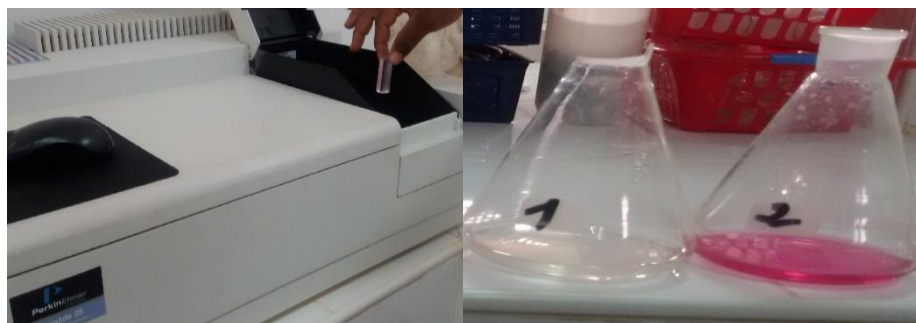
Photo 34 : Mesure de la densité optique de l'échantillon.
