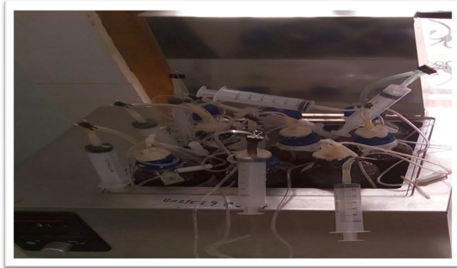
Photo IV.4 : Les réacteurs dans un bain marie chauffé et régulé à 37°C.
