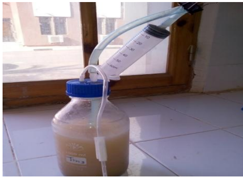
Photo IV.2 : Photo et schéma du digesteur au niveau de laboratoire.
