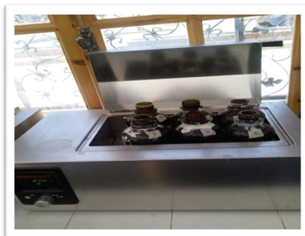
Photo IV.3 : Les réacteurs dans un bain marie chauffé et régulé à 37°C (milieu aérobie)
