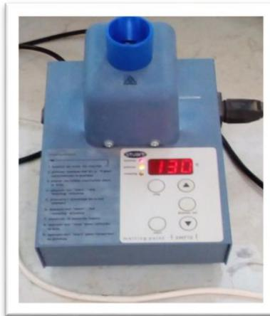
**Photo B.I-10: l'appareil de mesuré point de fusion**
