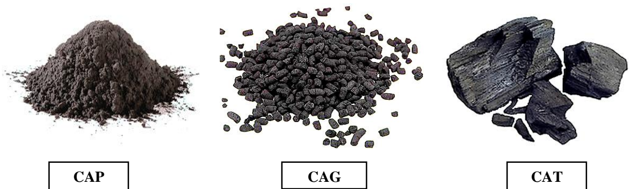
Figure 13 : Différentes formes de charbon actif.
