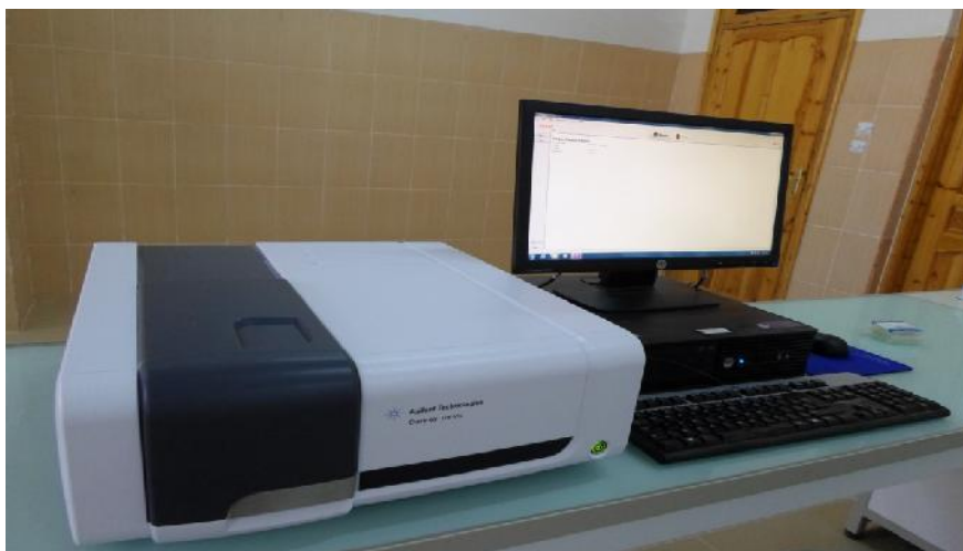
Figure IV.3 : l'appareil spectrophotomètre UV-visible.
