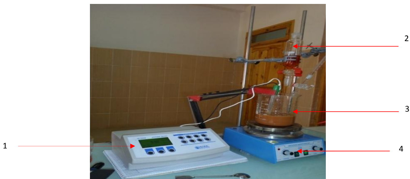
1 : pH mètre, 2 : solution de sel métallique, 3 : solution basique, 4 : agitateur magnétique.
