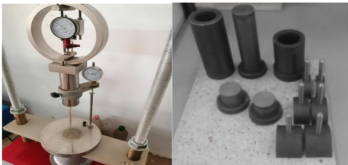
Figure. 4.8 Appareil d'essai de résistance à la compression non confinée (UCS) : cadre de charge et moules fendus
