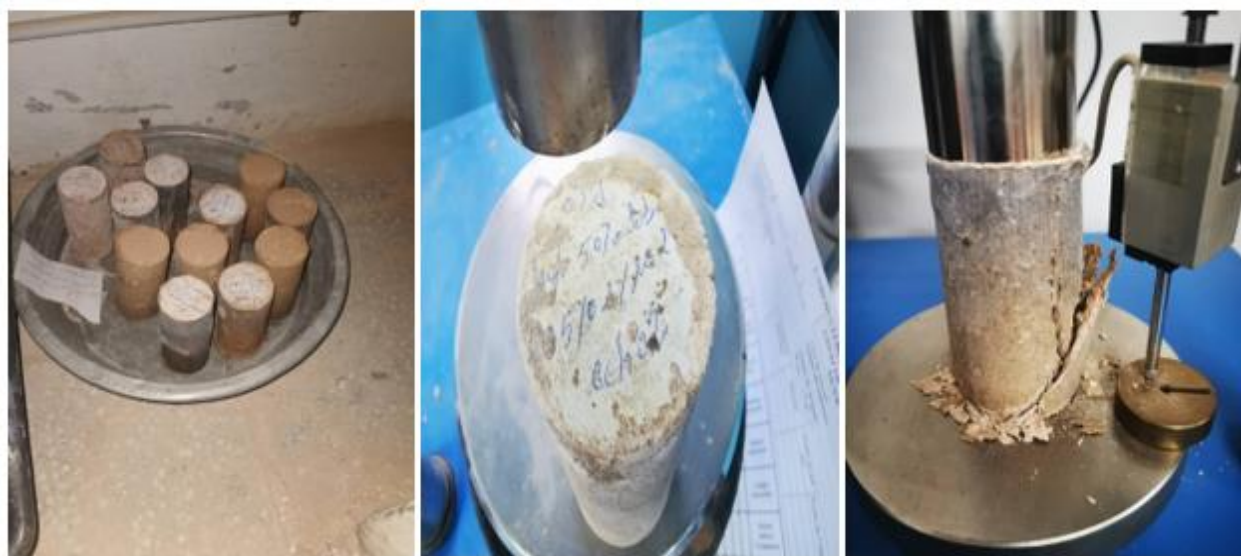
Figure 4.18 La mise en charge et rupture des cylindres UCS
