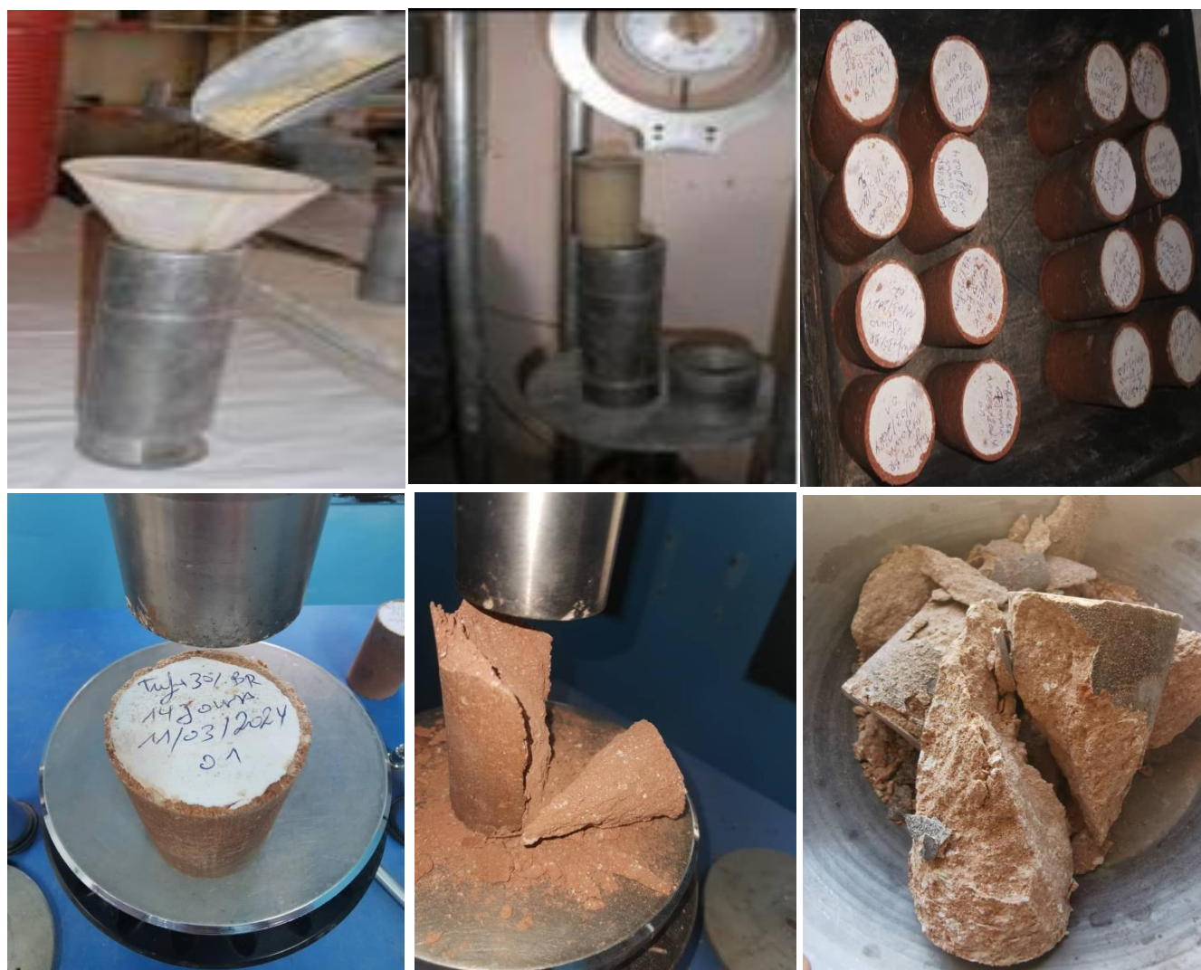
Figure 4.9 Étapes d'essai de résistance à la compression non confinée (UCS)
