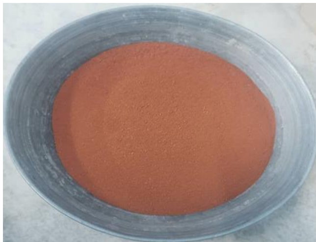
Figure 3.15 Déchets de briques rouges broyés
