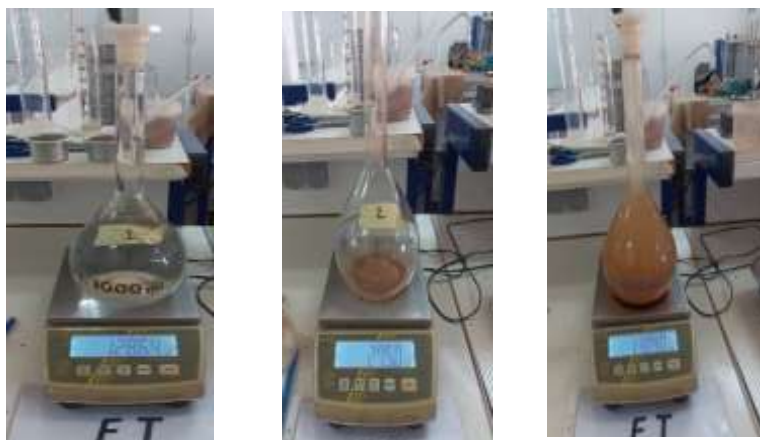
Figure. III. 6 : Essai pour déterminer la masse volumique absolue
