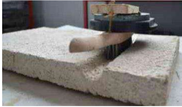
Figure.II. 18 : Test d'abrasion à la brosse métallique
