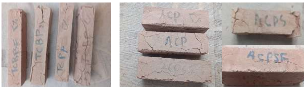
Figure. IV. 18 État des échantillons de nouveaux types de briques à base de toub recyclée et d'argile et de sable de dune après l'essai d'attaque chimique de Na_2SO_4
