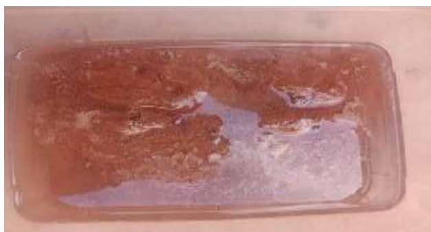
Figure IV. 13: Délitement des éprouvettes de béton de terre non stabilisé après l'immersion dans l'eau
