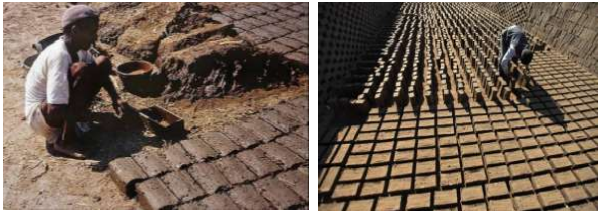
(a) (b) Figure.II. 9: (a) Démoulage des briques de terre, (b) Séchage des briques de terre. (Bérengère, 2015)
