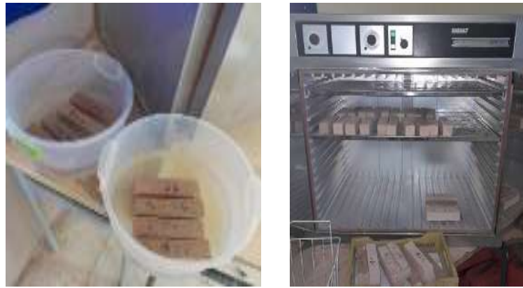
Figure. III. 22 : Conduite de l'essai d'humification-séchage
