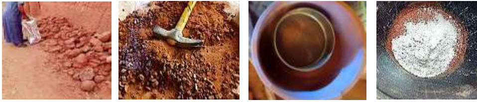
Figure. III. 11 : Malaxage à sec de la terre avec le stabilisant
