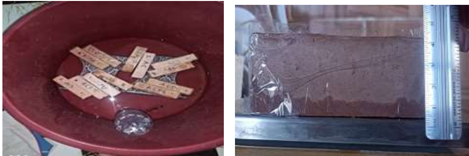
Figure. III. 20 : Essai remontée d'eau par capillarité
