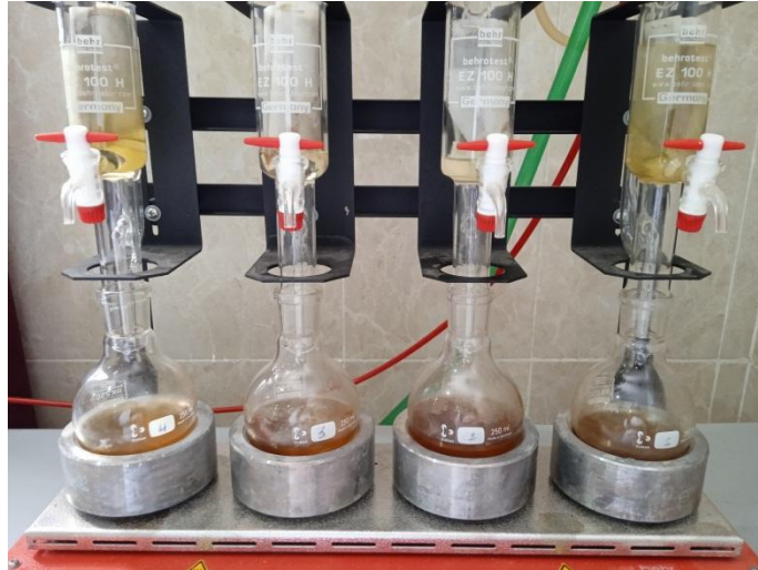
Figure 18. Procédé d'extraction Soxhlet (Originale)
