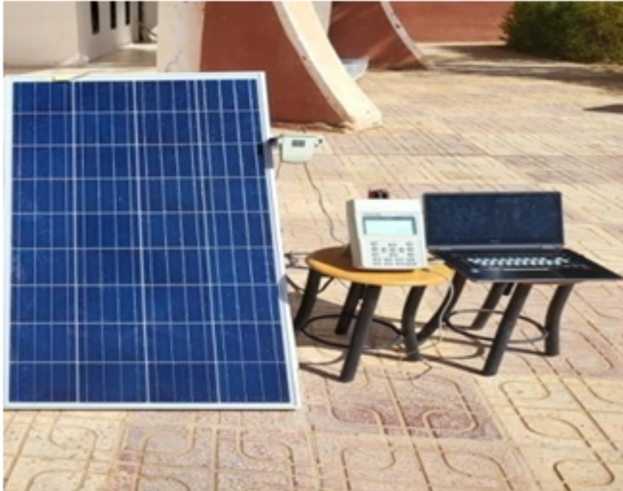
FIG. 3.14 : Plateforme expérimentale :modules PV,ordinateur et traceur (FI 103-AMS).
