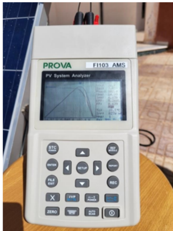
FIG. 3.15 : Caractéristiques électriques des modules PV de STC
