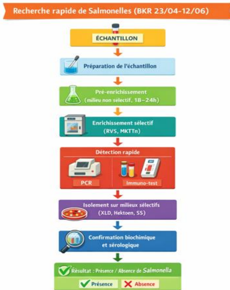
Figure 19. Schéma qui résume la méthode de recherche de Salmonelles méthode rapide ( BKR 23/04-12/06)
