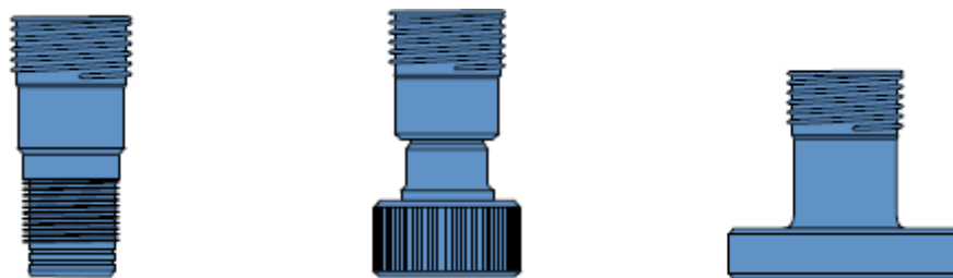
Figure 6.6 Adaptateurs de tête de puits [36]
