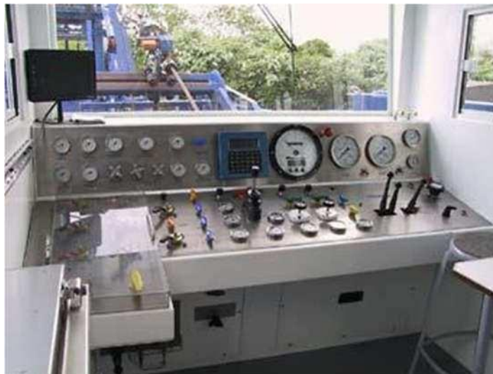
Figure 6.12 Photo de la cabine de contrôle de l'unité Coiled Tubing [39].
