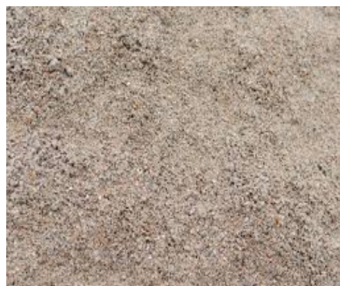
Figure III-5: Sable de béton recyclé
