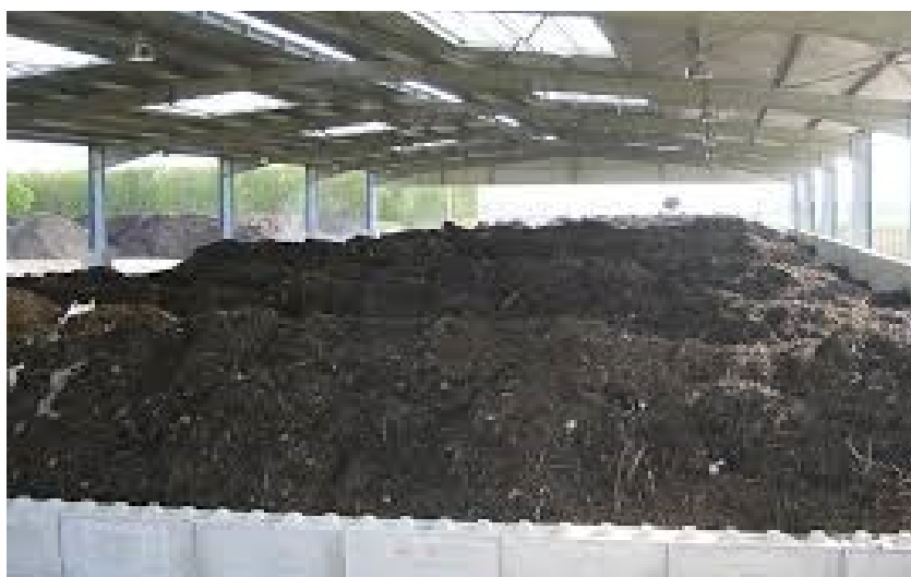
Figure IV-3: Compostage des boues d'épuration
